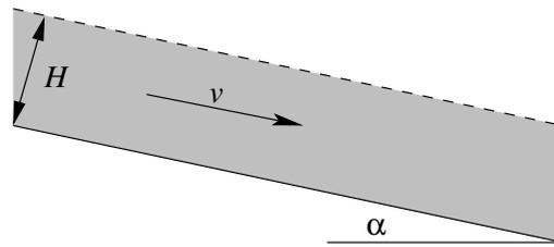
1. Berechnen Sie die Geschwindigkeits- und Druckverteilung der stationären Strömung, die sich längs einer schiefen Ebene aufgrund der Schwerkraft ausbildet. Die Höhe der Strömung senkrecht zur Platte sei  $H$ , der Neigungswinkel  $\alpha$ .
