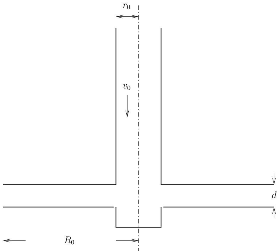
An einer Röhre mit kreisförmigem Querschnitt (Radius  $r_0$ ) ist ein Kreisring mit Radius  $R_0$  befestigt. Durch die Röhre wird Luft mit der Geschwindigkeit  $v_0$  geblasen, die wie eingezeichnet aus der Röhre in den Spalt zwischen den Kreisringen austritt und an den Rändern der Ringe in die Atmosphäre entweicht (Atmosphärendruck  $p_a$ ).
