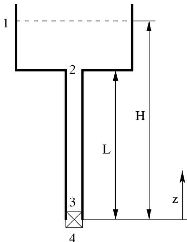
An einem großen, oben offenen Wasserreservoir ist ein Fallrohr der Länge  $L$  mit Querschnitt  $A_2$  senkrecht angebracht. Das Rohr wird mit einem kleinen Ventil am Ende während der Schließzeit  $T$  so geschlossen, dass der Volumenstrom linear bis auf null abnimmt. Berechnen Sie den zeitlichen Verlauf des Druckes  $p_3(t)$  vor dem Ventil und der Geschwindigkeit  $c_4(t)$  der Strömung unter dem Ventil.
