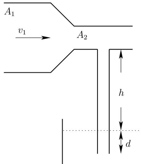
Luft wird mit der Geschwindigkeit  $v_1$  und dem Druck  $p_1$  durch ein Rohr mit Querschnitt  $A_1$  gepresst. Das Rohr verengt sich auf den Querschnitt  $A_2$ . Die Dichte der Luft  $\varrho$  sei konstant. In das kleinere Rohr mündet ein weiteres Rohr, das in einer Flüssigkeit der Dichte  $\varrho'$  endet. Berechnen Sie die Ansaughöhe  $h$ .
