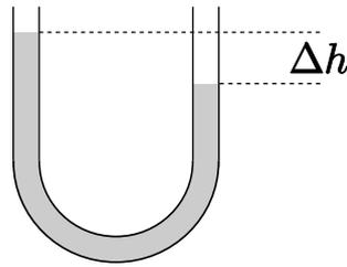
Eine Wassersäule der Dichte  $\rho$  befindet sich, wie in der Skizze gezeigt, in einem U-Rohr mit Querschnitt  $A$ , wobei anfangs (zur Zeit  $t = 0$ ) der Höhenunterschied der beiden Flüssigkeitssäulen  $\Delta h$  beträgt.
