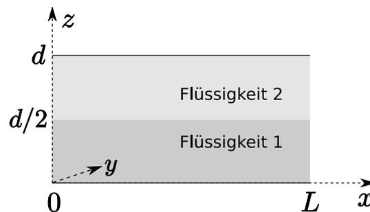
Zwischen zwei in  $y$ -Richtung unendlich ausgedehnte Platten in der  $x$ - $y$ -Ebene mit Abstand  $d$  befinden sich zwei inkompressible Newton'sche Flüssigkeiten der Dichte  $\rho$  mit Viskosität  $\mu_1$  bzw.  $\mu_2$ , die jeweils den halben Raum zwischen den Platten ausfüllen, wie in der Skizze. Der Druck im Querschnitt zwischen den Platten an der Stelle  $x = 0$  sei  $p(0)$ , der Druck an der Stelle  $L$  gleich  $p(L)$ .
