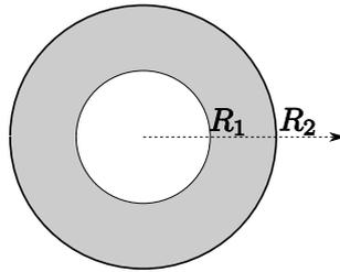
Zwischen zwei kreisförmigen Röhren der Länge  $L$  mit Radien  $R_1 < R_2$  befinde sich eine inkompressible Newton'sche Flüssigkeit mit kinematischer Viskosität  $\nu$ , wie in der Skizze. Die Flüssigkeit wird durch eine Druckdifferenz  $\Delta p$  zwischen den Rohrenden getrieben.
